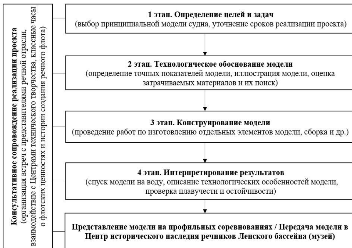
Рис. 1. Этапы технологического процесса по разработке модели судна
